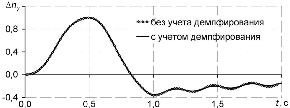
Рисунок 5 – Приращение перегрузки в центре тяжести самолета, модель с неравномерными распределениями параметров по размаху крыла
