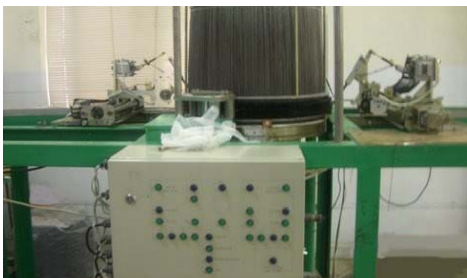
Рисунок 6 – Диаметральное расположение подающих модулей на установке
