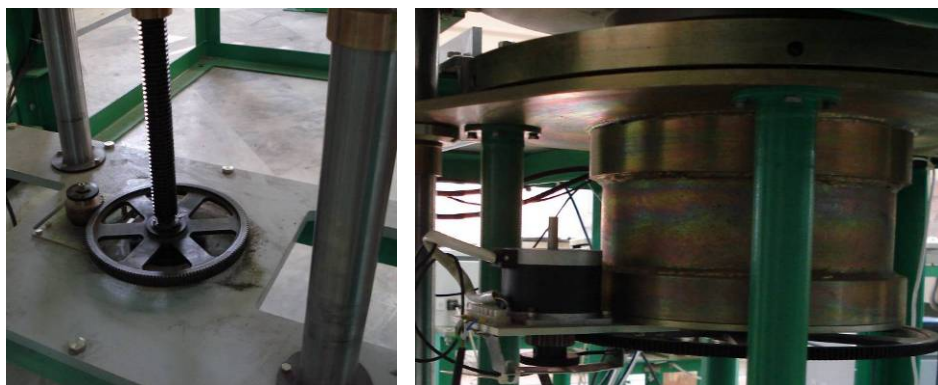
Рисунок 5 – Модули подъема и поворота стола
