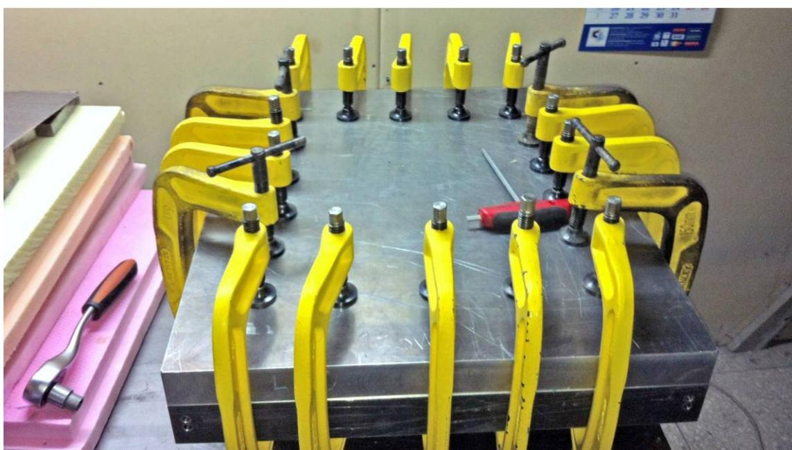
Рисунок 6 – Собранная для проведения режима склейки пресс-форма
