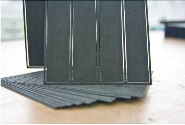
Рисунок 2 – Внутренние надрезы окон для рамок линз Фринеля
