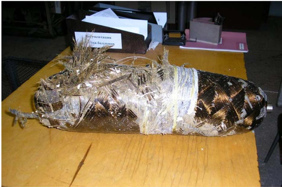
Рисунок 2 – Характер безосколочного разрушения баллона
