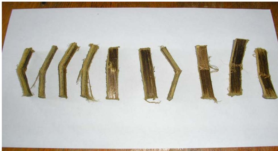
Рисунок 1 – Образцы из органопластика после проведения испытаний на ударную вязкость
