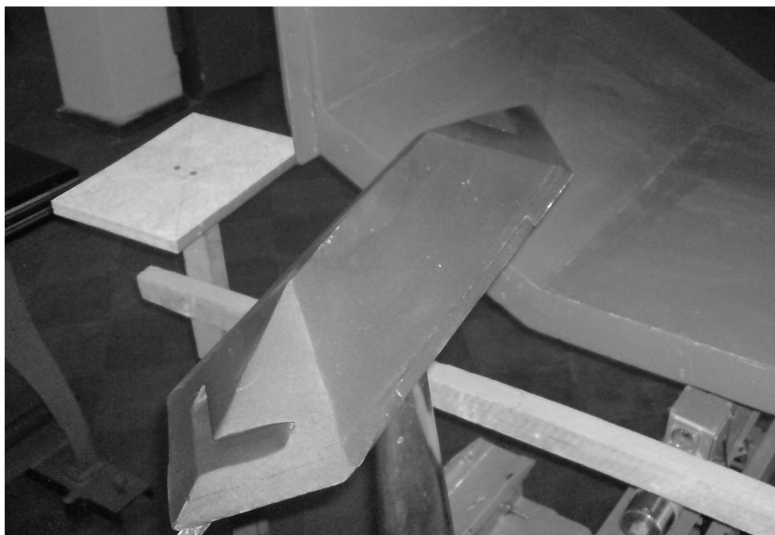
Рисунок 4 – Фотография внешнего вида модели треугольного фюзеляжа самолета с преобразуемым крылом в рабочей части аэродинамической трубы Т-1
