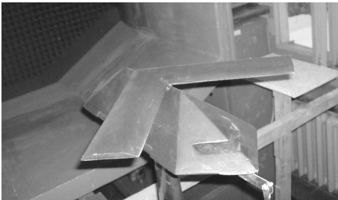
Рисунок 3 – Фотография внешнего вида модели самолета с преобразуемым крылом и фюзеляжем треугольной формы поперечного сечения в рабочей части аэродинамической трубы Т-1 (крыло убрано)
