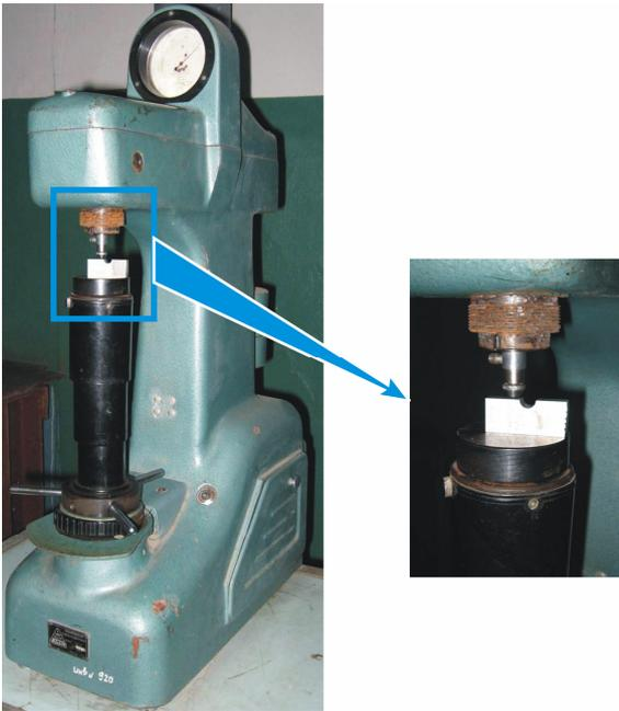
Рисунок 8 – Устройство для измерения твердости ТК-2
