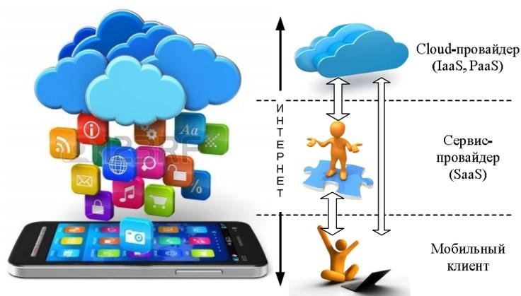
Рис. 1. Многоуровневая архитектура гетерогенных систем распределенной обработки и хранения информации
