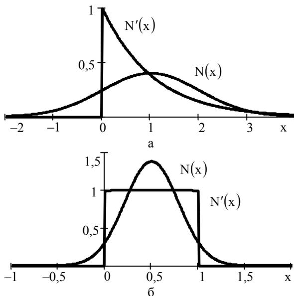
Рис. 8. Аппроксимация негауссовых распределений нормальными и усеченными нормальными ПРВ: а – экспоненциальный ЗР; б – равномерный ЗР
