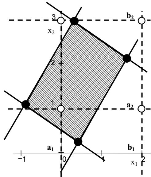
Рис. 2. Трансформация исходной области усечения в результате преобразования корреляции,  $r_{12} = 0,5$
