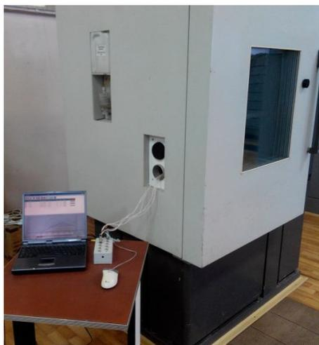
Рис. 3. Контроль температуры при испытании на воздействие повышенной/пониженной температуры окружающей среды с использованием КРТ
