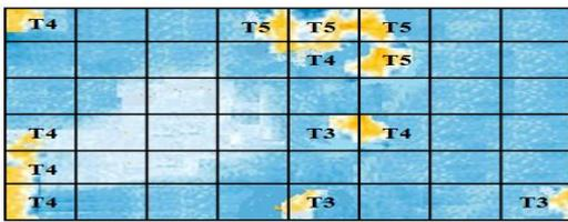
Рис. 5. Карта температур изображения термограммы, характеризующая поврежденные участки миксера
