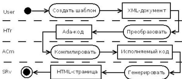
Рис. 1. Схема динамической генерации HTML страниц: User – Web программист, HTTr – HTML транслятор, ACm – Ada компилятор, Srv – сервер
