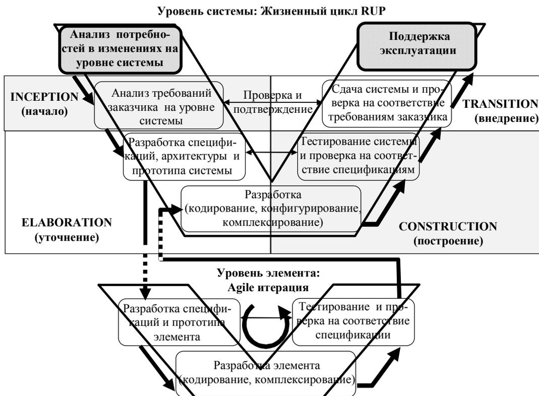
Рис. 3. Применение нескольких методологий разработки ПО в рамках одного проекта создания сложной информационной системы
