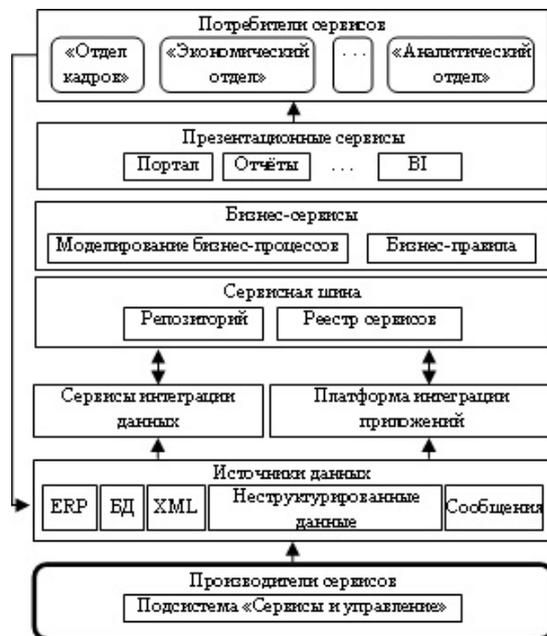
Рис. 9. Обобщённая многоуровневая архитектура интеграции подсистемы «Сервисы и управление» на основании COA
