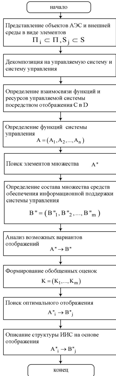
Рис. 3. Последовательность реализации подхода к обоснованию структуры ИИС АЭС
