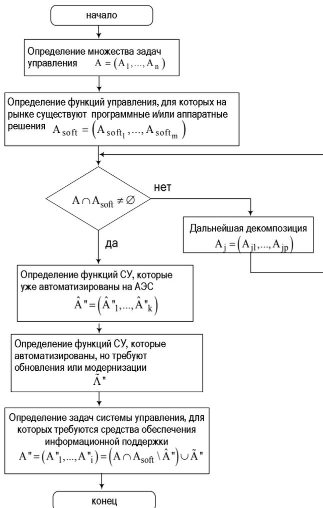
Рис. 5. Алгоритм поиска элементов множества  $A$
