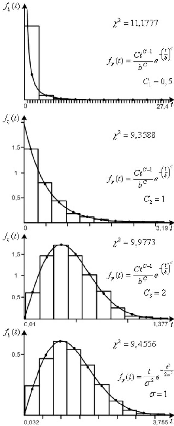
Рис. 2. Результаты моделирования моментов отказа  $\{t_{yi}\}$  одного блока системы (законы Вейбулла и Релея)
