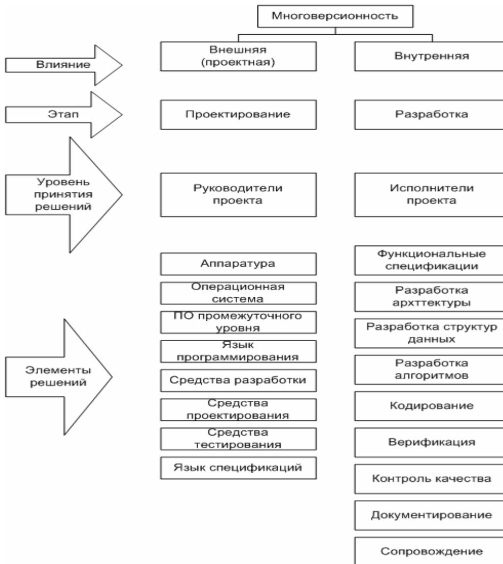
Рис. 1. Классификация видов версионной избыточности ПО
