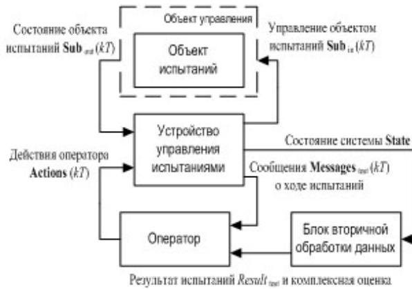
Рис. 1. Общий вид модели системы испытаний СТС
