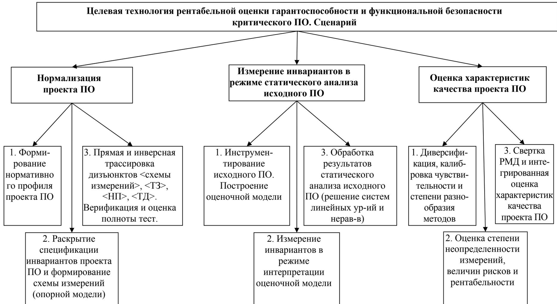
Рис. 2. Декомпозиция функциональной IDEF0 – модели сценария целевой технологии. Дерево узлов 0-1-2 уровней
