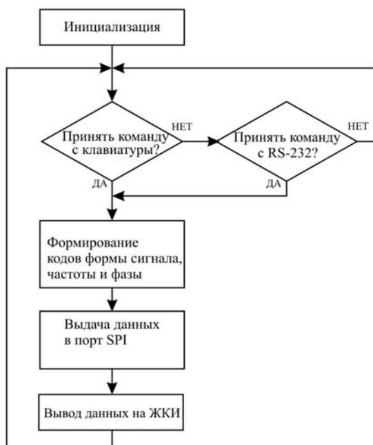
Рис. 3. Алгоритм работы программного обеспечения микроконтроллера
