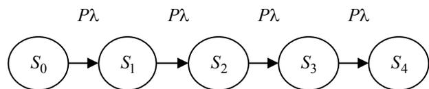
Рис. 1. Граф переходов в модели СКК
