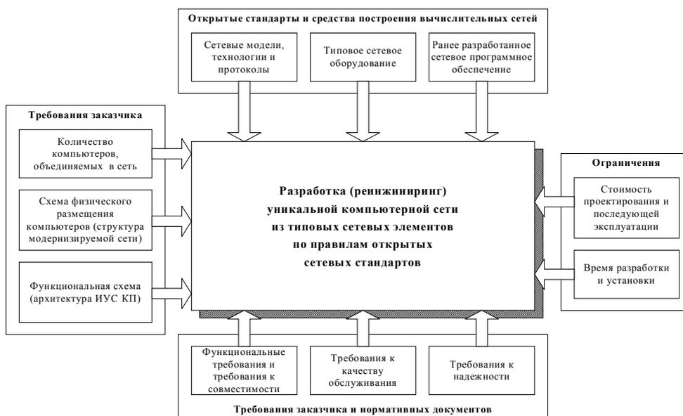
Рис. 1. Исходные данные, используемые в процессе разработки и реинжиниринга компьютерных сетей
