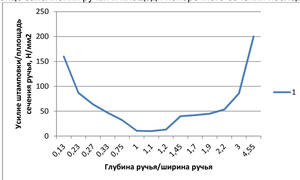
Рис. 3. Зависимость удельного усилия заполнения ручья от соотношения его глубины и поперечного размера
