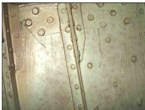
Рис. 4. Характер развития трещины обшивки в районе стыка ЦЧФ и ХБ
