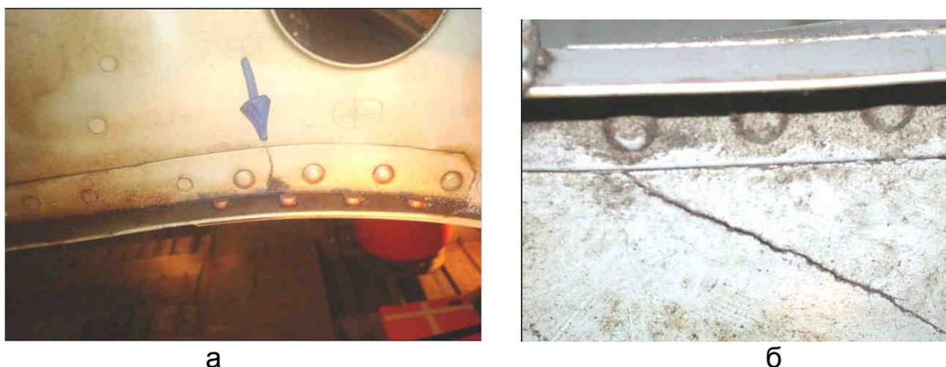
Рис. 3. Характер развития трещины шпангоутов хвостовой балки:
