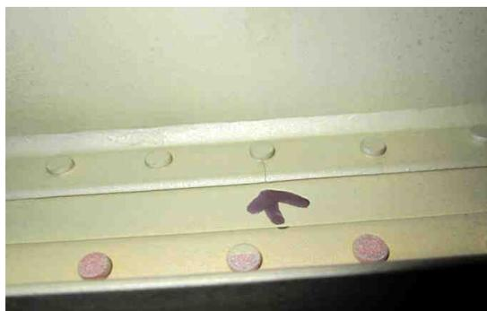
Рис.5. Характер развития трещины стрингеров – трещины от отверстия под заклепку
