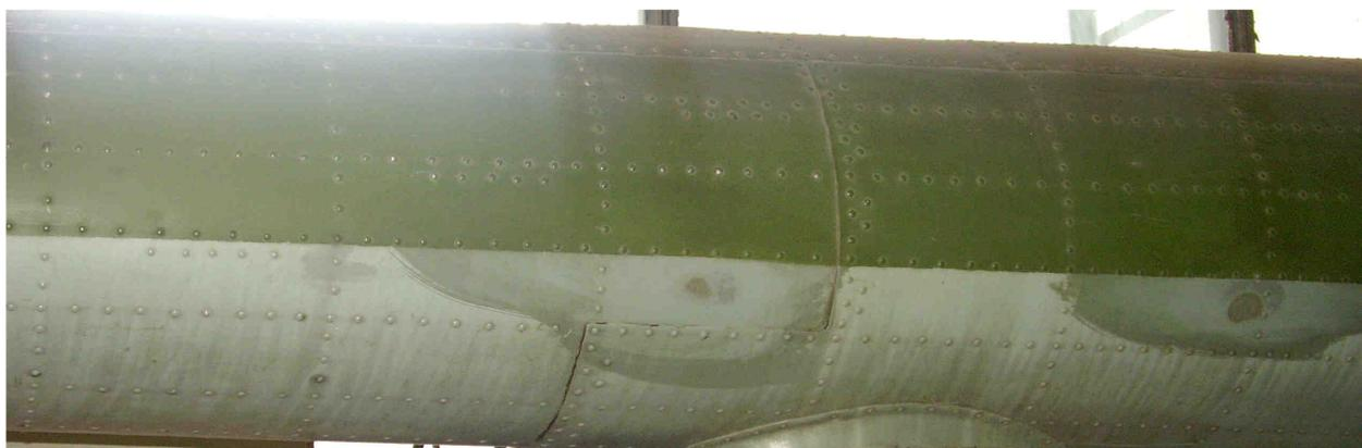
Рис. 1. Типичные регулярные зоны конструкции хвостовых балок вертолетов транспортной категории
