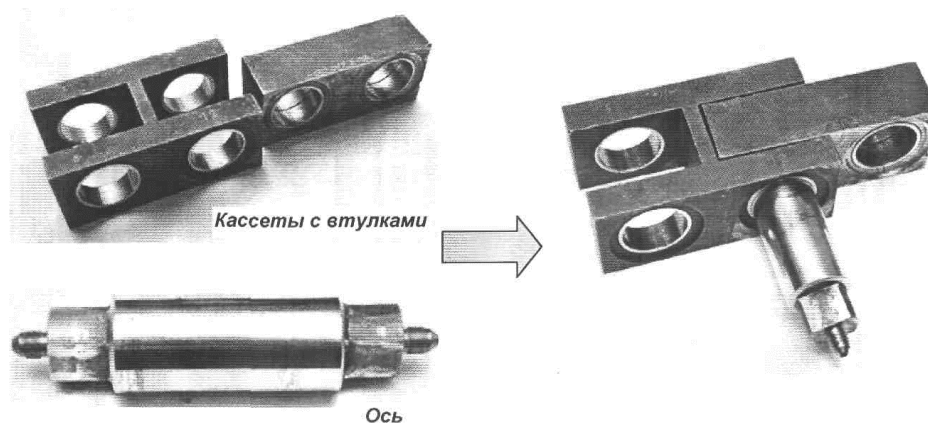
Рис. 3. Сборка кассет с запрессованными втулками с осью перед установкой на испытательный стенд
