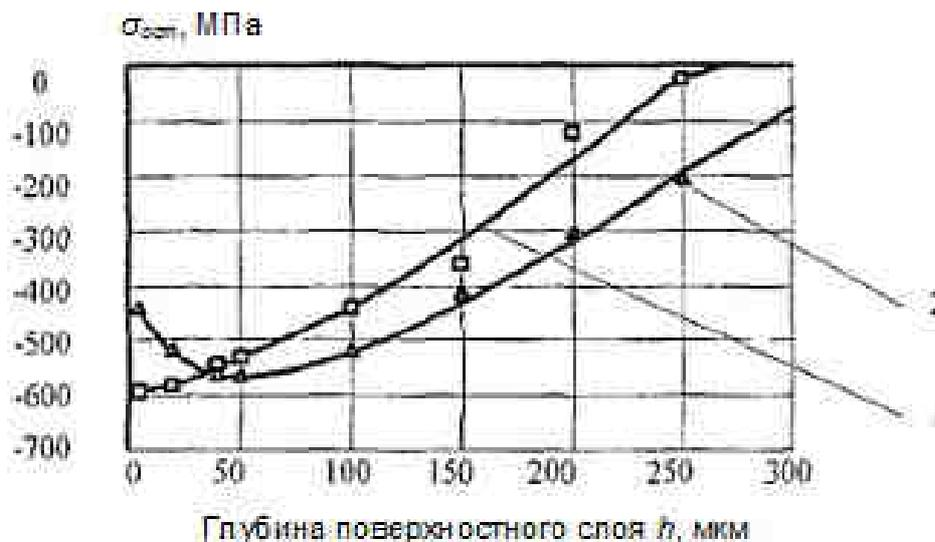
Рис. 1. Изменение остаточных напряжений сжатия в зависимости от глубины поверхностного слоя [4]
