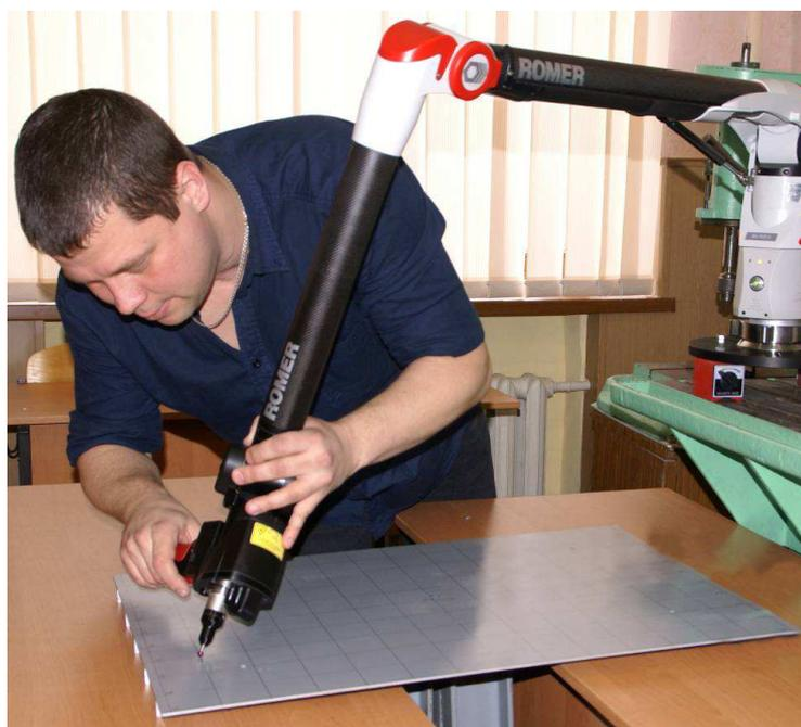
Рис. 6. Процесс измерения координат реперных точек поверхности образца панели с помощью координатно-измерительной машины типа «рука» ROMER Absolute Arm
