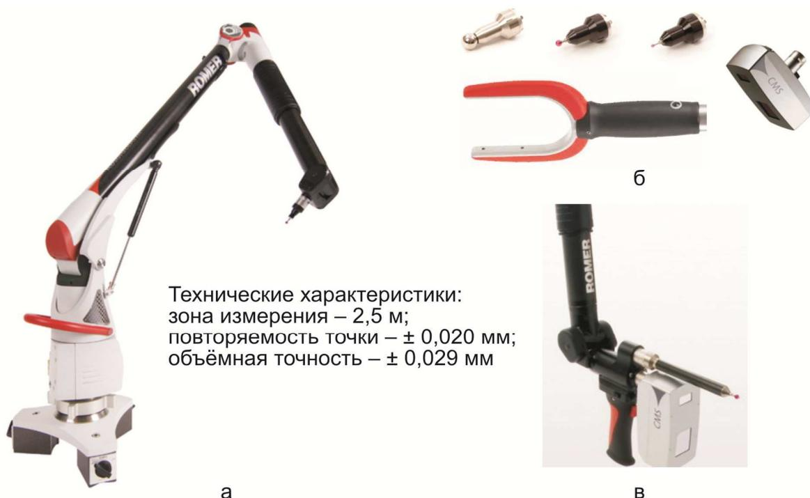
Рис. 4. Переносная координатно-измерительная машина типа «рука»:
