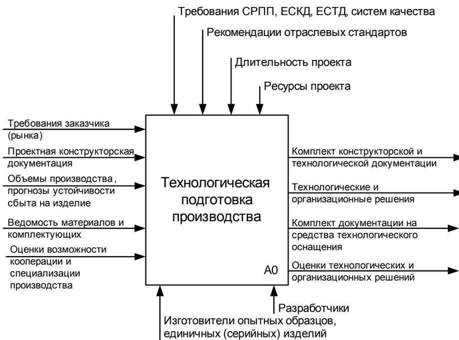
Рис. 2. Общая функциональная модель процесса ТПП
