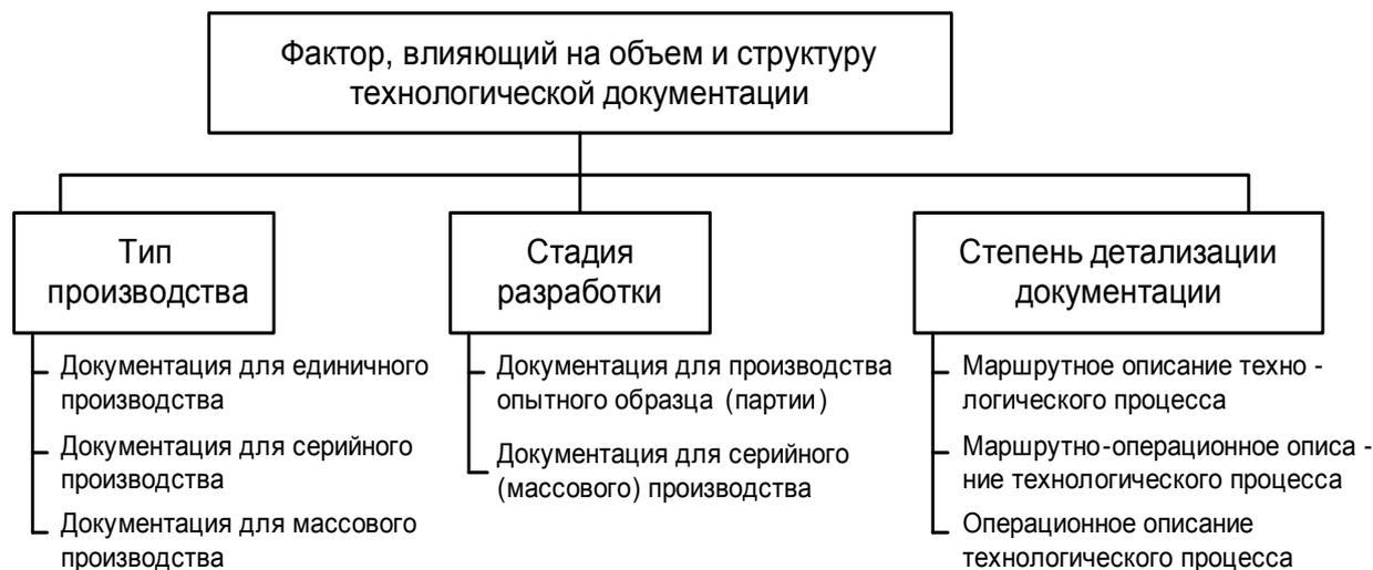
Рис. 4. Классификация факторов, на влияющих структуру и объем технологических документов
