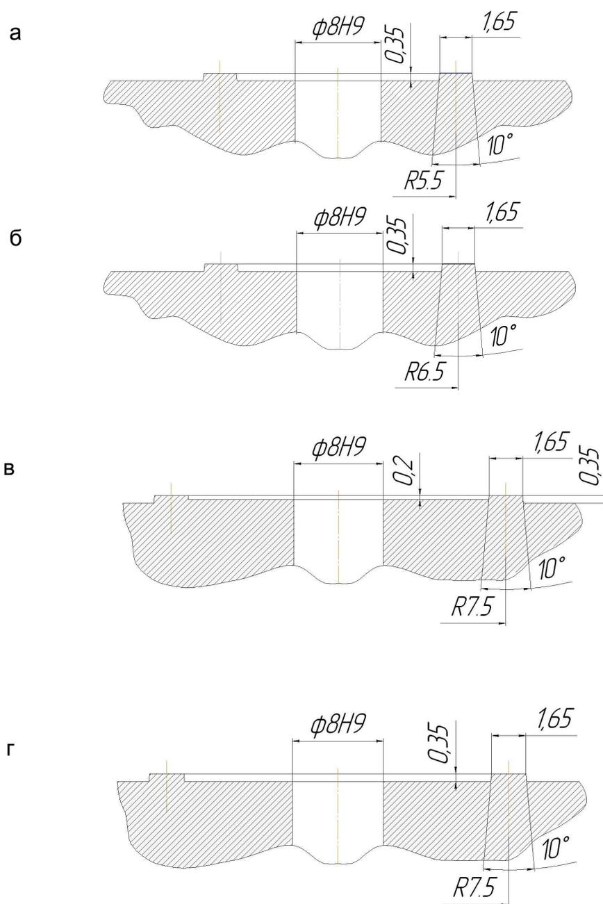
Рис.13. Геометрические размеры буртиков круговых барьерных обжимок:
