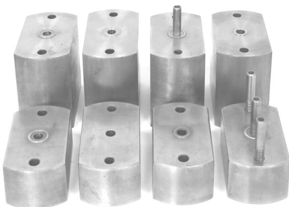
Рис. 10. Обжимки для кругового барьерного обжатия
