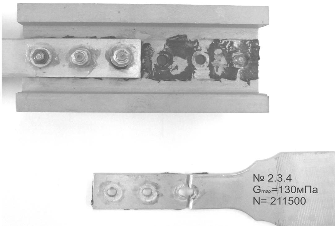
Рис. 16. Характер усталостного разрушения образца односрезного болтового соединения в зоне крайнего крепежного элемента с круговым барьерным обжатием, заполненным герметиком УЗ0МЭС-5м между поверхностями профиля и полосы, а также ВЗ-27м в зоне контакта шайбы и головки болта после усталостного разрушения в условиях циклических растягивающих нагрузок при уровне напряжений
