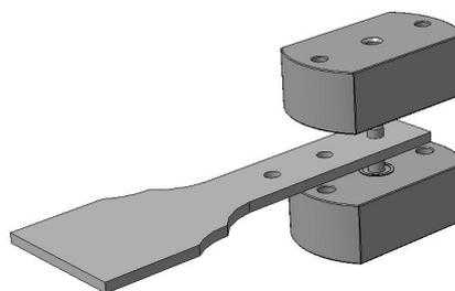
Рис. 11. Трехмерная модель полосы с отверстиями и обжимок
