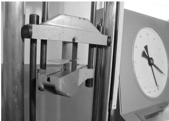
Рис. 14. Установка полосы и обжимок для выполнения кругового барьерного обжата на испытательной машине ZD 10/90
