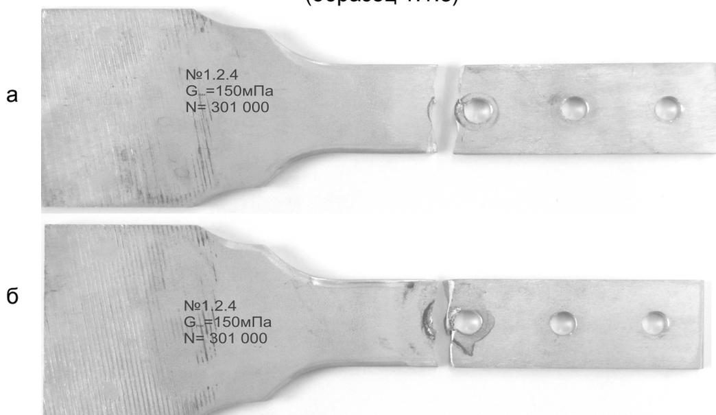
Рис. 7. Характер усталостного разрушения полосы односрезного образца болтового соединения при экспериментальных исследованиях в условиях фреттинг-коррозии при уровне напряжений  $\sigma_{бр\ min} = -30$  МПа  $\sigma_{бр\ max} = 150$  МПа (образец 1.2.4): а - в зоне контакта шайбы 2-8-14-Ан.Окс. ОСТ 1 34509-80, б - в зоне контакта поверхностей полосы и профиля
