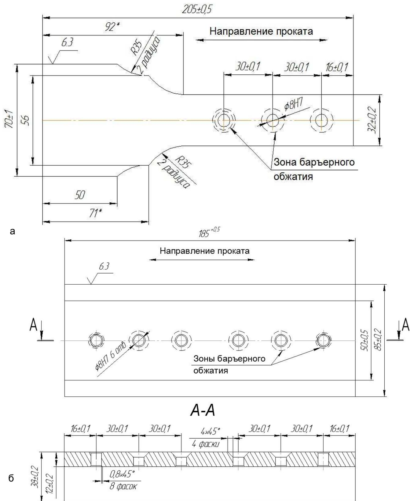
Рис. 3. Геометрические размеры деталей для изготовления образцов:
