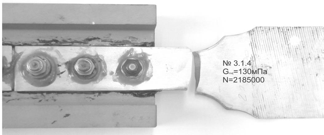
Рис. 17. Характер усталостного разрушения полосы с круговым барьерным обжатием, покрытой полимерным наполнителем ВЗ-27м (образец 3.1.4)
