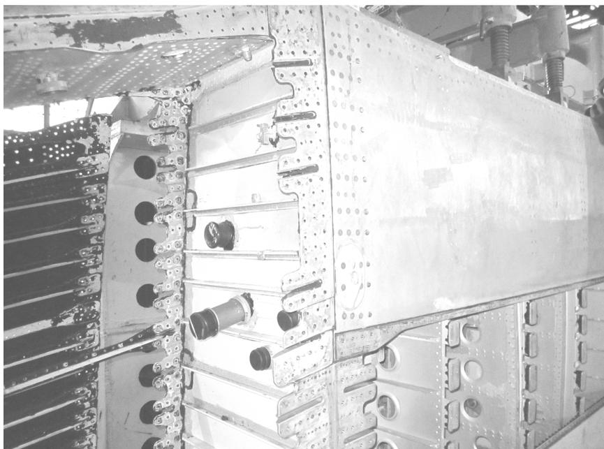
Рис. 1. Общий вид соединения панелей крыла и профиля разьема
