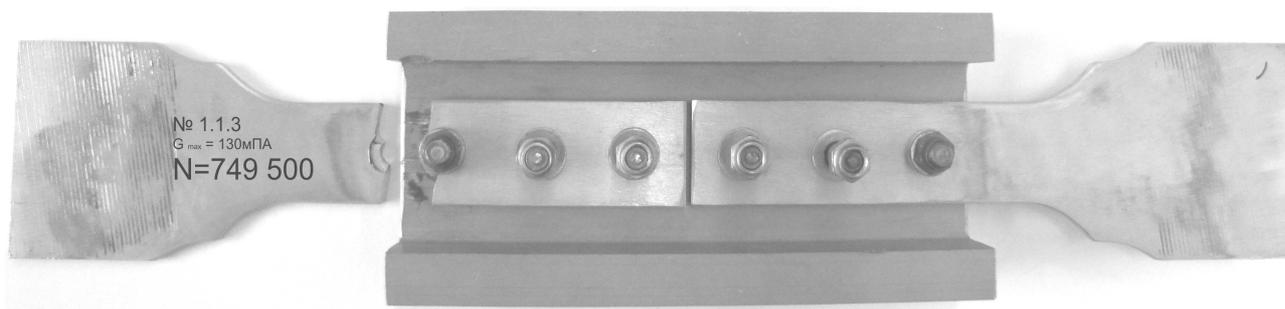
Рис. 6. Зона и характер усталостного разрушения односрезного образца болтового соединения с осевым и радиальным натягами при экспериментальных исследованиях в условиях фреттинг-коррозии в зоне контакта болта 8-34- Ан. Окс. ОСТ1 31066-86 и шайбы 2-8-14-Ан.Окс. ОСТ 1 34509-80 при уровне напряжений  $\sigma_{бр\ max} = 130$  МПа (образец 1.1.3)
