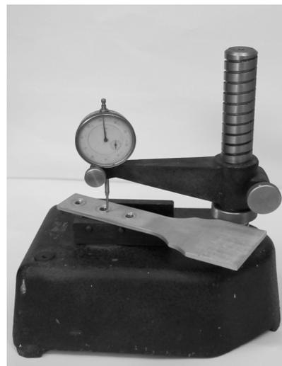
Рис. 15. Контрольно-измерительное приспособление для измерений глубины обжата
