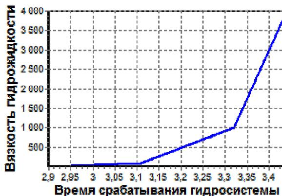
Рис. 7. График зависимости времени срабатывания ГС от вязкости гидрожидкости
