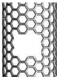
Рис. 4. Структура дефекта, полученного удалением 12 атомов углерода
