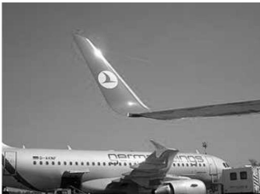
Рис. 1. КАП на крыле самолета
