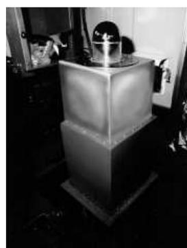
Рис. 11. Датчик D-Dot AD-60, Prodyn Technologies
