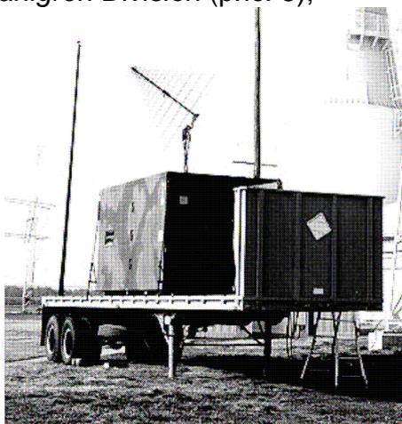
Рис. 8. Логопериодическая антенна в положении с вертикальной поляризацией
