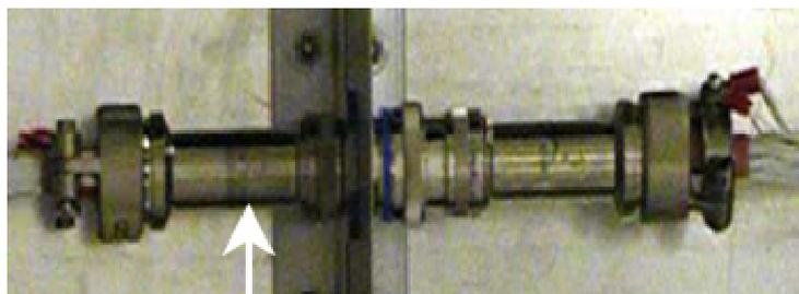
Рис. 17. Стандартный экранированный соединитель
