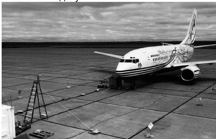
Рис. 4. Измерение передаточной функции Boeing 737 для удовлетворения сертификационных требований по стойкости к HIRF, 1997 г.
