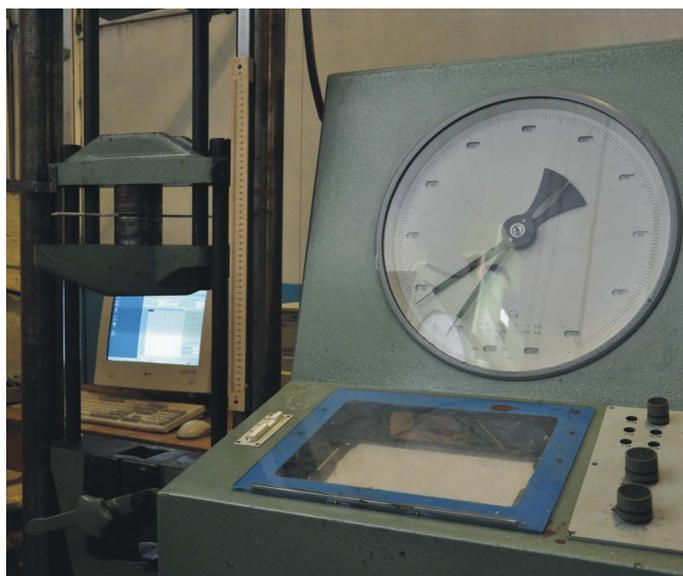
Рис. 7. Установка образца для выполнения совместного локального и барьерного обжата полосы в зоне цилиндроконического отверстия на установке ZD 10/90
