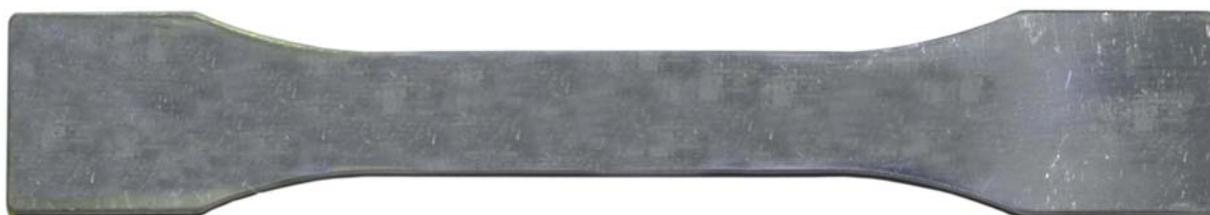
Рис. 2. Заготовка для изготовления образцов типовых моделей конструктивных элементов планера самолета в зоне разъемных болтовых соединений
