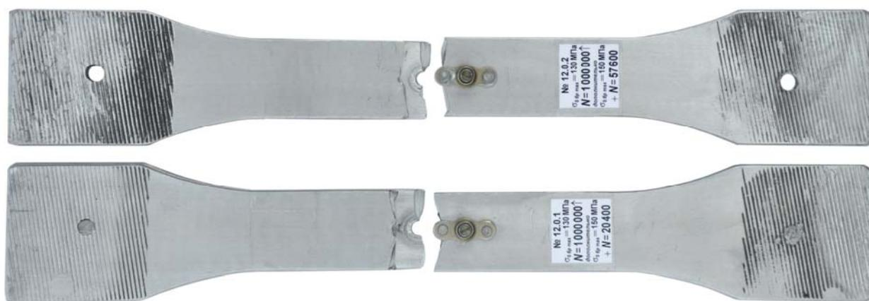
Рис. 9. Зоны и характер усталостного разрушения модели не нагруженного на срез продольного разъемного болтового соединения, элементы которого в зоне цилиндрического отверстия обработаны дорнованием стенок отверстия, а в зоне цилиндрического отверстия обработаны совместным обжатию переходных зон и круговым барьерным обжатию
