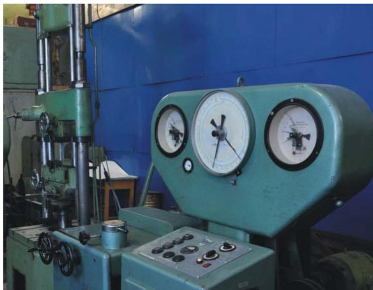
Рис. 4. Установка образца на испытательной машине ЦДМ-10ПУ
