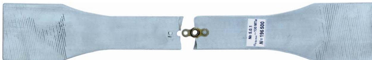
Рис. 5. Характер усталостного разрушения образцов соединения полосы с цилиндрическим отверстием и анкерной гайки
