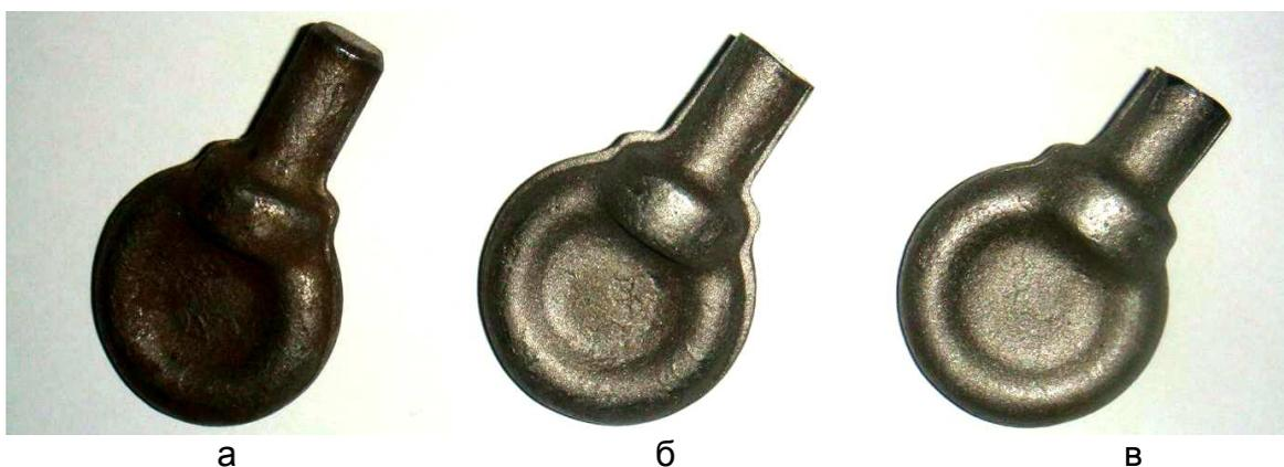
Рис. 3. Экспериментальные образцы: а – образец с перегретой структурой материала; б – образец с недогретой структурой материала; в – образец с оптимальными параметрами
