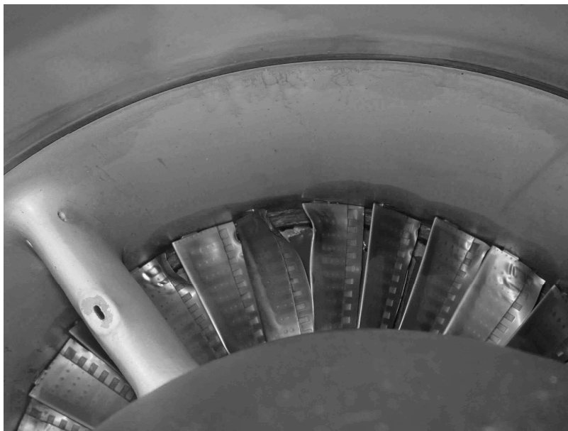
Рис. 1. Характер повреждения компрессора двигателя
