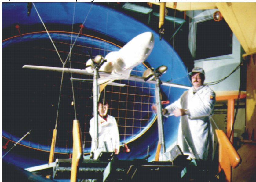
Рис. 1. Испытания модели самолета Ан-140 с приставными имитаторами двигателей в аэродинамической трубе АТ-1
