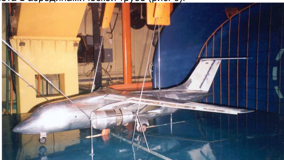
Рис. 6. Модель самолета Ан-148 с присоединенными ИМДВТ с решетчатым реверсором
