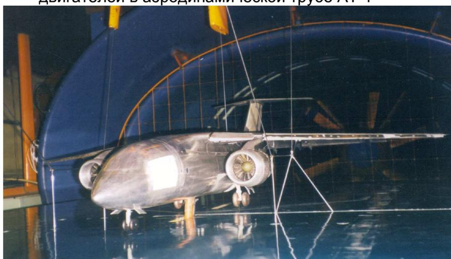
Рис. 6. Испытания механизированной модели самолета Ан-148 с присоединенными имитаторами двигателей Д436-148 в аэродинамической трубе АТ-1
