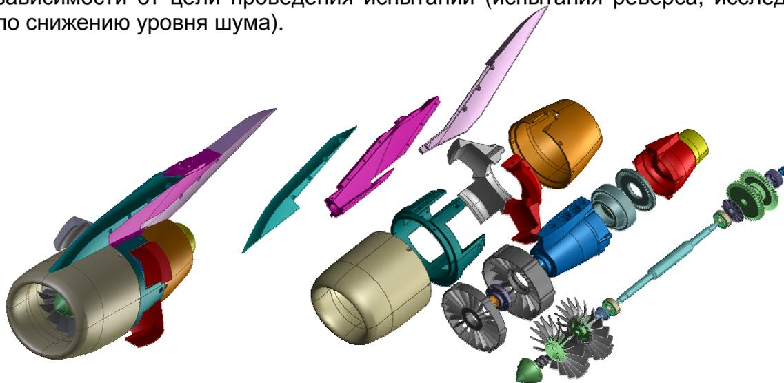
Рис. 2. Имитатор турбовентиляторного двигателя
