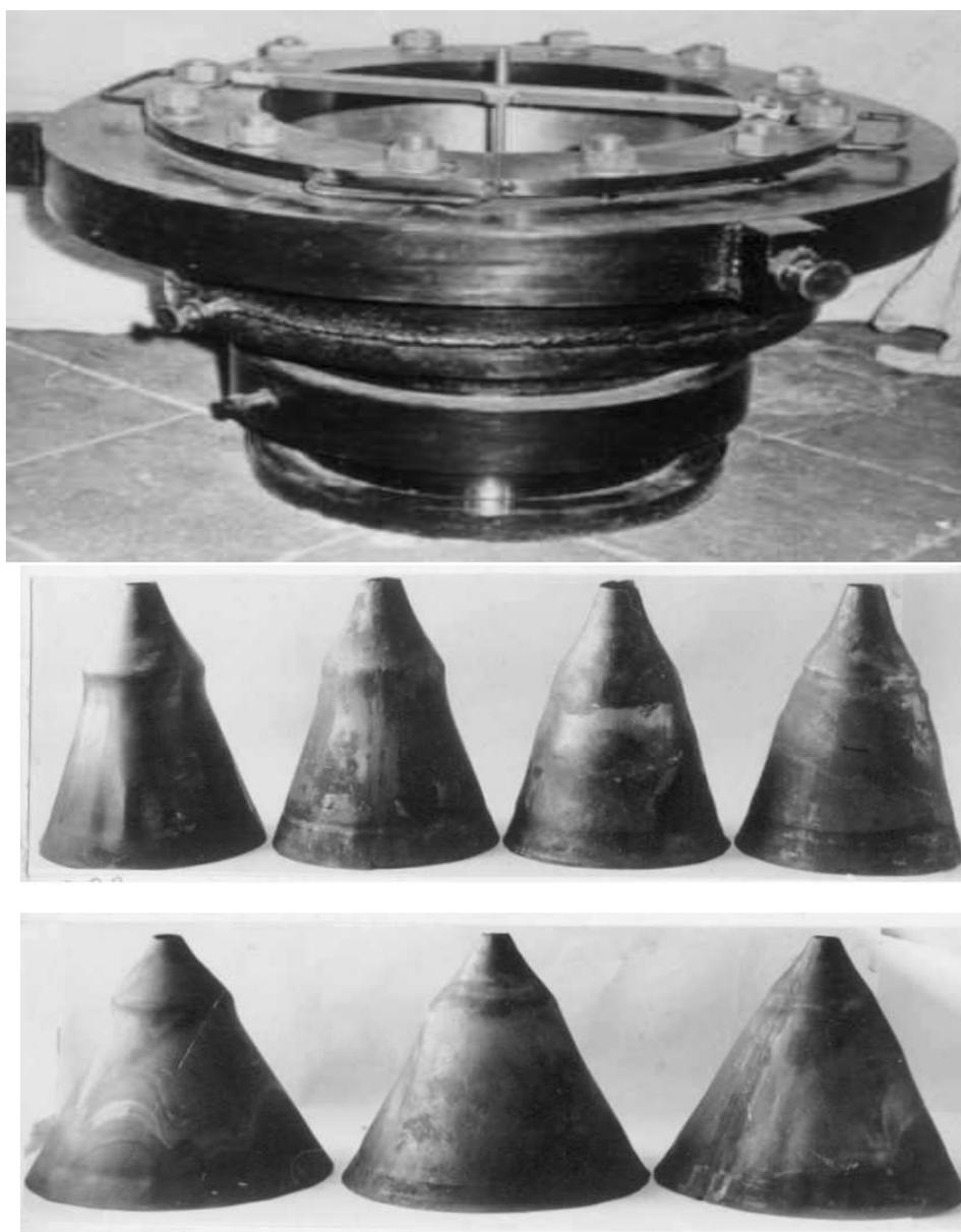
Рис. 6. Оснастка и детали, изготовленные методом штамповки взрывом
