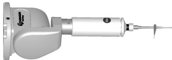
Рис. 4. Застосована «Г»-подібна щупова оснастка
