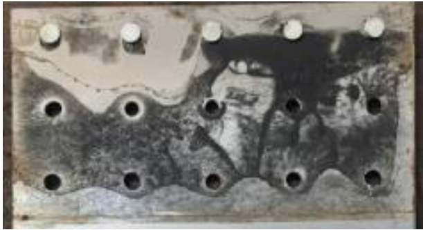
Рис. 2. Внутрішні поверхні заклепкових з'єднань з ділянками проникнення сполуку AV-8
