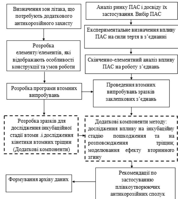
Рис. 6. Компоненти комплексного методу контролю побічних негативних ефектів при застосуванні ПАС
