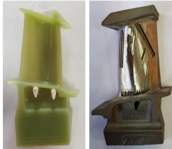
Рис. 2. Зовнішній вигляд стрижня залитого пластиковою моделлю й розріз виливка лопатки
