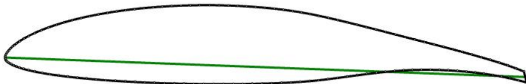
Рис. 1. Зображення аеродинамічного профіля EPPLER 664 (EXTENDED)
