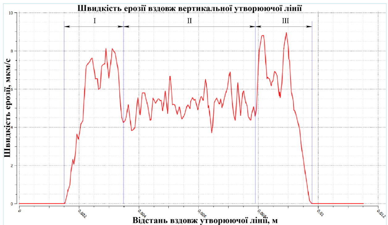
Рис. 6. Графік швидкості ерозії вздовж вертикальної утворюючої лінії, варіант 1.5: \alpha=34^\circ і S=0
