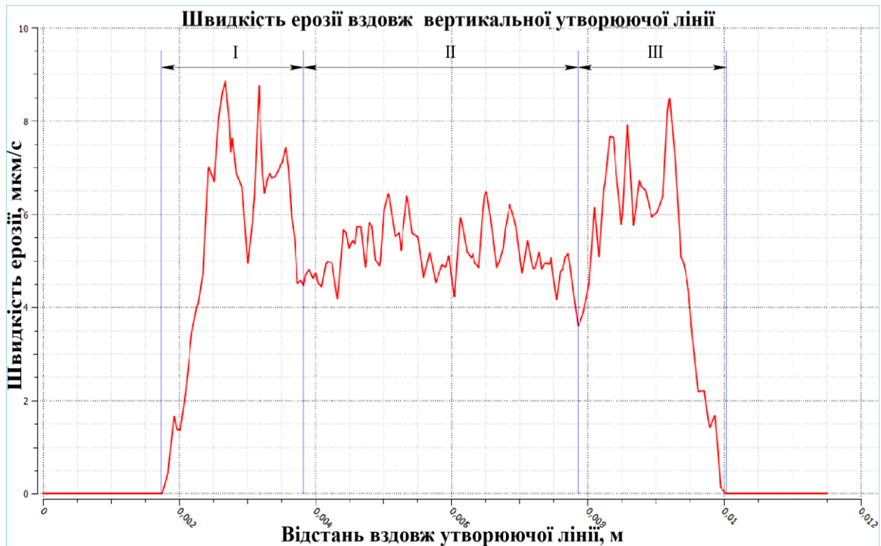
Рис. 7. Графік швидкості ерозії вздовж вертикальної утворюючої лінії, варіант 1.7: \alpha=38^\circ і S=0
