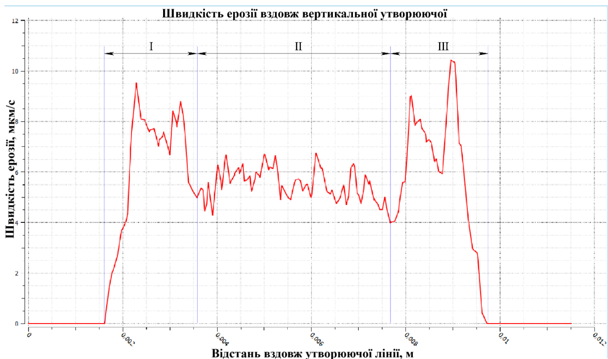
Рис. 4. Графік швидкості ерозії вздовж вертикальної утворюючої лінії, варіант 1.1: \alpha=26^\circ і S=0
