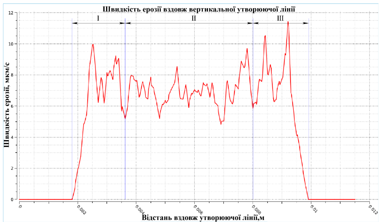
Рис. 10. Графік швидкості ерозії вздовж вертикальної утворюючої лінії, (контрольний варіант 1.0 \alpha=26^\circ , S=0 , зернистість абразивних часток 100 мкм)
