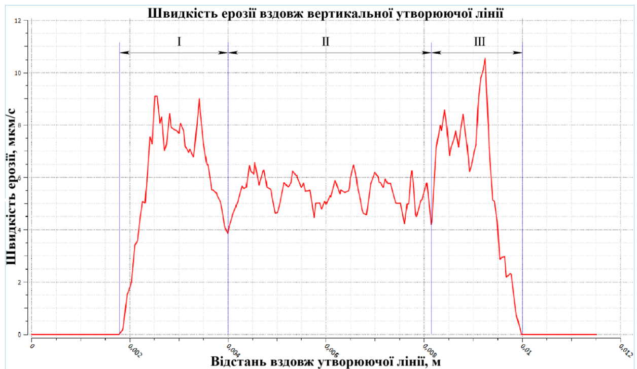
Рис. 5. Графік швидкості ерозії вздовж вертикальної утворюючої лінії, варіант 1.3: \alpha=30^\circ і S=0
