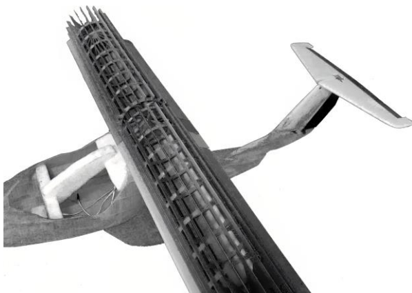
Рис. 4. Експериментальна розрахункова модель крила №2 з роторним рушієм, встановлена на фюзеляжі літаку прототипу
