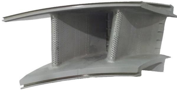
Рис. 1. Элемент соплового аппарата турбины АГТД
