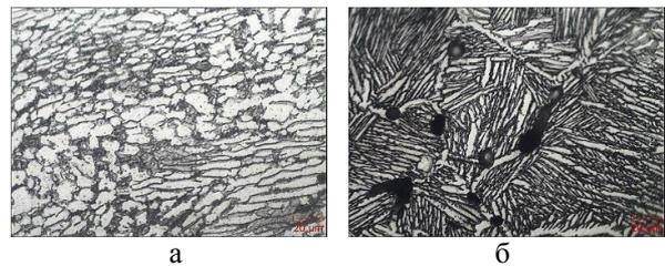
Рис. 3. Микроструктура прутка титанового сплава ВТ8 (а) и опытного спеченного порошкового сплава типа ВТ8 (б)
