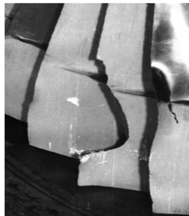
Рис. 2. Характер повреждений рабочих лопаток вентилятора двигателя типа А после попадания крупной птицы при специальных стендовых испытаниях
