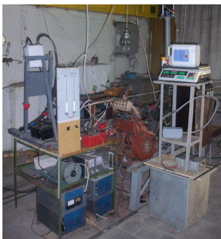
Рис. 1. Экспериментальная установка на базе двигателя с искровым зажиганием 2Ч 7,2/6
