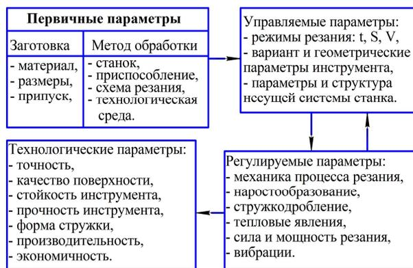
Рис. 2. Схема регулирования процесса обработки
